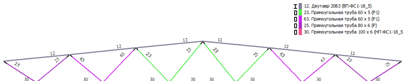
Рис. 2.3.1.1. Стропильная ферма пролётом 18 м, применяемая для пятого снегового района (ФС-18/10-2.86). Графическая интерпретация расчётной модели с маркировкой жесткостей элементов расчётной модели.
